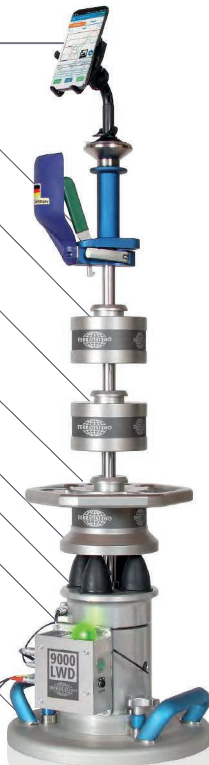
Piastra di carico "Tripla D" per cambiare il diametro della piastra 100/150/300 mm
